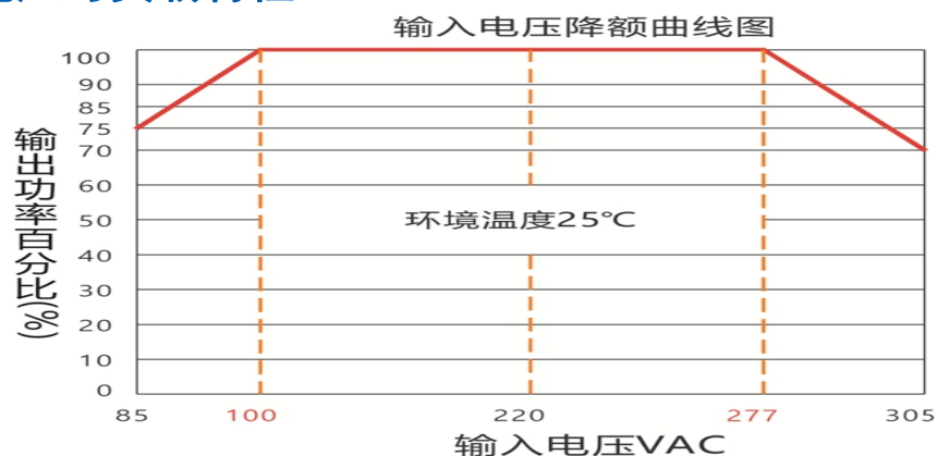
输入电压与负载特性曲线
